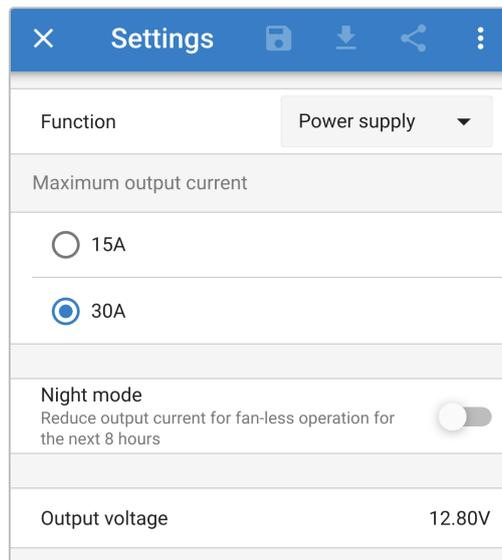
Nella modalità alimentazione è anche possibile attivare la modalità corrente bassa o la modalità notturna e specificare la tensione in uscita desiderata.
