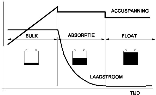
Drie-Traps laadkurve: Fase A is Bulk (snelladen). Fase B is Absorptie, waarin de accu van 80 tot 100% geladen wordt. Fase C is de onderhoudsfase (Float).
