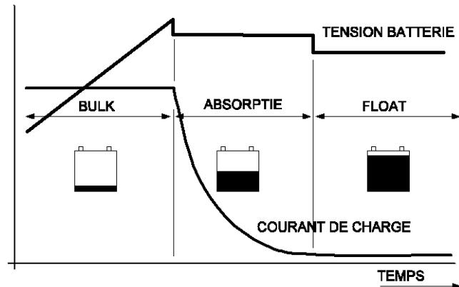
Courbe de charge à 3 étapes. Etape A : Bulk, la batterie est chargée rapidement, jusqu'à 80% environ. Etape B : Absorption, la batterie est chargée de 80-100%. Etape C : Float, la charge de la batterie est maintenue à 100%
