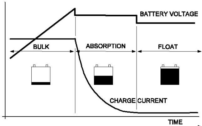
Curva de carga de tres etapas. Fase A: BULK, para carga rápida del 0 al 80%, Fase B: ABSORCIÓN, la batería se carga del 80 al 100%. Fase C: FLOTACIÓN, la batería se mantiene en estado de carga total.
