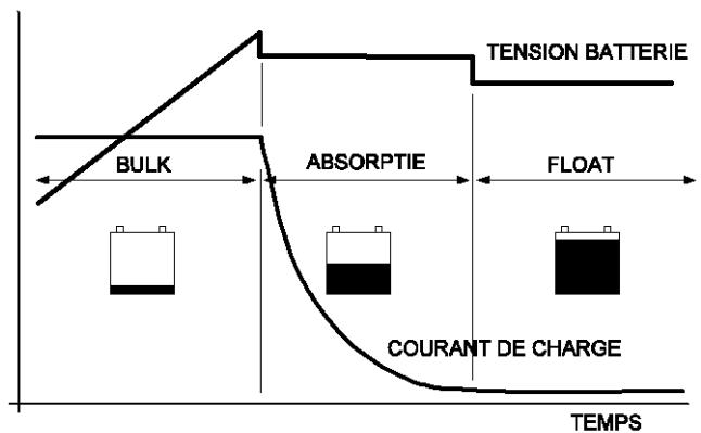
La curva di carico a 3 stadi. Lo stadio A: Bulk è per la carica veloce da 0 all'80%; lo stadio B Absorption, la batteria è caricata dall'80% al 100%; Stadio C: Float, la batteria è mantenuta nello stato di piena carica.
