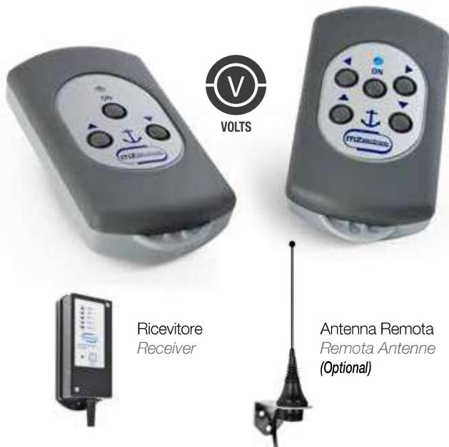
I radiocomandi MZ permettono, come le pulsantiere, l'utilizzo di salpancora, eliche di manovra, gruette e passerelle privilegiando la praticità grazie ad un comando senza fili, maneggevole e comodo. Disponibili a 2 e 4 canali di comando, con ricevitore e trasmettitore stagno IP66. Modalità di frequenza 433Mhz o 868Mhz.
