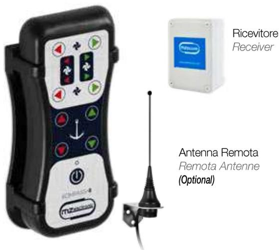
Il radiocomando Kompass-8 permette di gestire fino ad 8 canali di trasmissione e quindi manovrare due verricelli e due eliche di manovra. Con il tasto di scelta rapida è possibile anche azionare contemporaneamente due eliche di manovra, rendendo ancora più facile l'ormeggio. Trasmettitore galleggiante IP67. Modalità di frequenza 868Mhz o 915Mhz.
